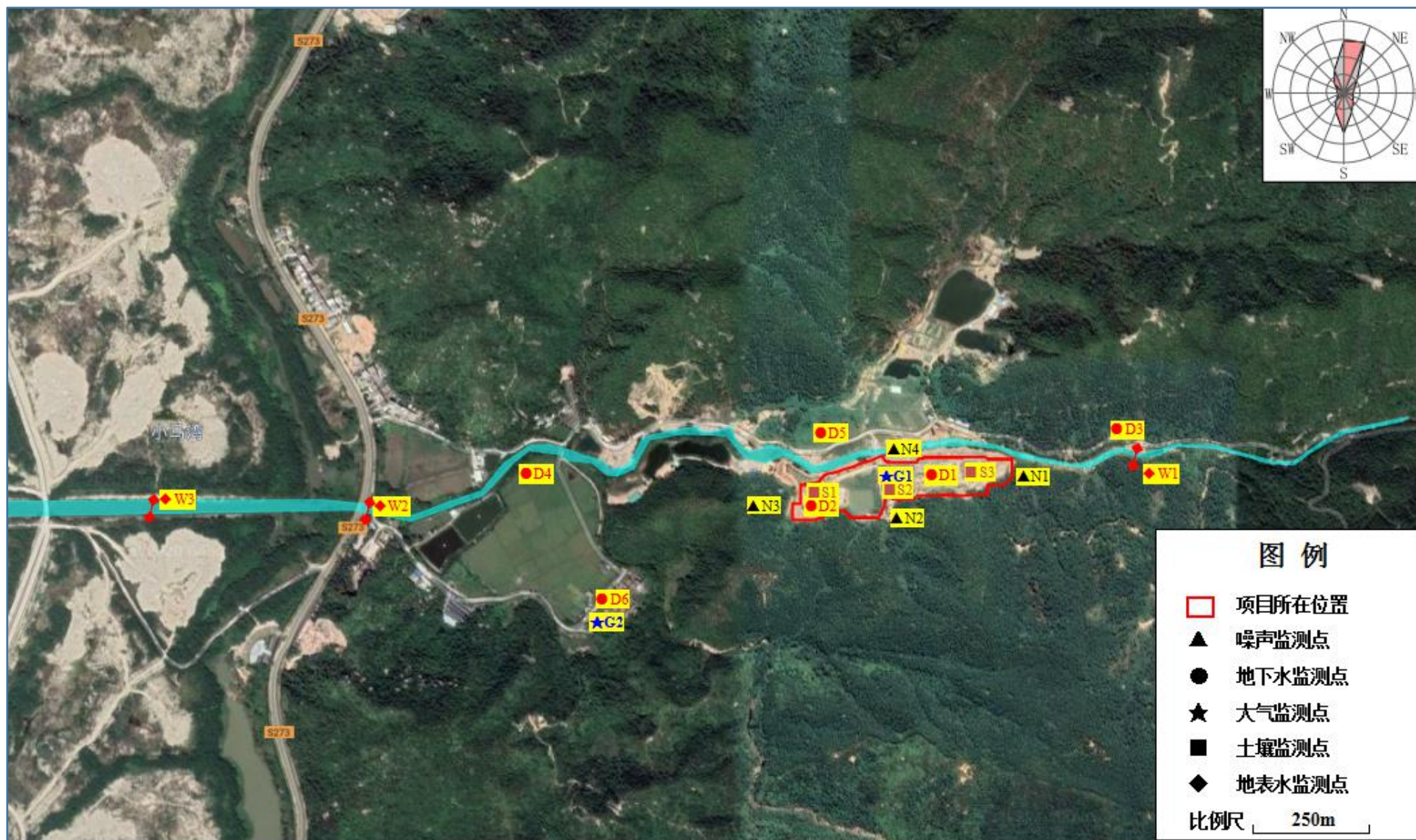
图 5-1 地表水、地下水、噪声、土壤、大气监测点位布设图
